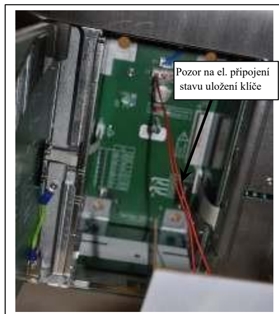
Kabeláž mezi deskou elektroniky a deskou pro klíče
